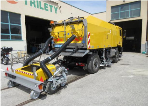
Image 1 : les roues fortes charges à bandage pneumatique et les roues à boudin de Blickle, installées sur un appareil de nettoyage sur rails à gorge, séduisent par leurs faibles émissions de bruit.
