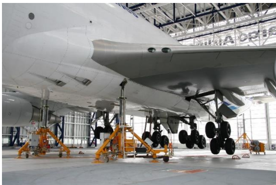
Image 1 : Les trépieds de levage HYDRO pour la maintenance des avions et des réacteurs sont équipés de roulettes fortes charges LSD-SETH en acier mécano soudé de Blickle.
