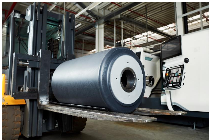
Image 5 : Roue motrice fortes charges avec bande de roulement polyuréthane Blickle Extrathane ® .
