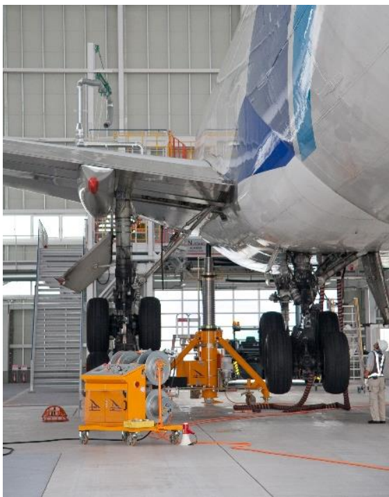
Image 2 : Les roulettes spéciales possèdent une faible résistance au roulage et permettent le positionnement précis du trépied de levage.
